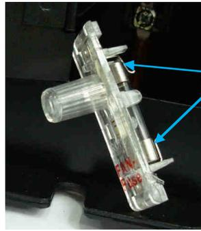
Предохранитель вентиляторов охлаждения радиатора.
